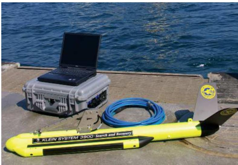
L'intérêt de l'utilisation d'un sondeur latéral est double :
