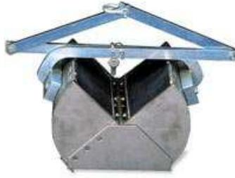
Les bennes sont descendues sur le fond de la mer au bout d'un câble en acier, avec les mâchoires ouvertes. Dès que les mâchoires touchent le fond, le ressort qui maintient les mâchoires ouvertes est relâché. Au moment de la remontée, les mâchoires se referment et emprisonnent une quantité de sable ou de sédiments du fond de la mer.
