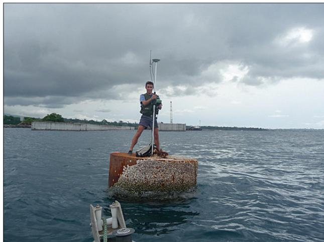
*Lors de la prise de vue, l'image satellitaire est déformée par divers facteurs (roulis, tangage, lacet, altitude, ... et d'autres paramètres orbitographiques). Pour corriger ces déformations, on a besoin de quelques mesures géodésiques réelles, prises sur le terrain (points d'appui GPS précis).*
