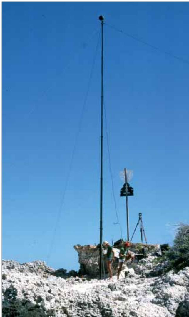
*Mât télescopique supportant l'antenne du telluromètre (atoll Beautemps-Beaupré)*
