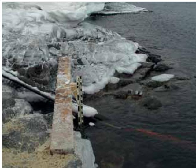
*Mesures de tirant d'eau « sabot de mire » (socle scellé sur la roche
