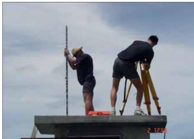
Opération de nivellement sur le toit de l'abri du marégraphe à Tubuaï
