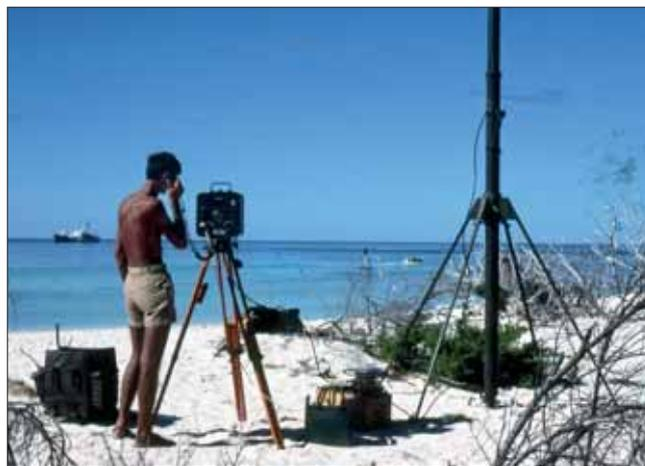
*Mesure au telluromètre MRA 5 avec mât télescopique déporté (en fond le BH1 L'Estafette au mouillage devant l'île de la Surprise)*
