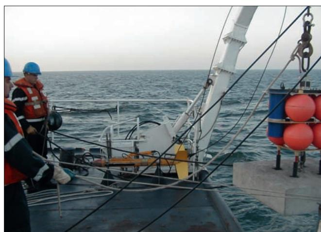
Mise à l'eau d'un courantomètre
