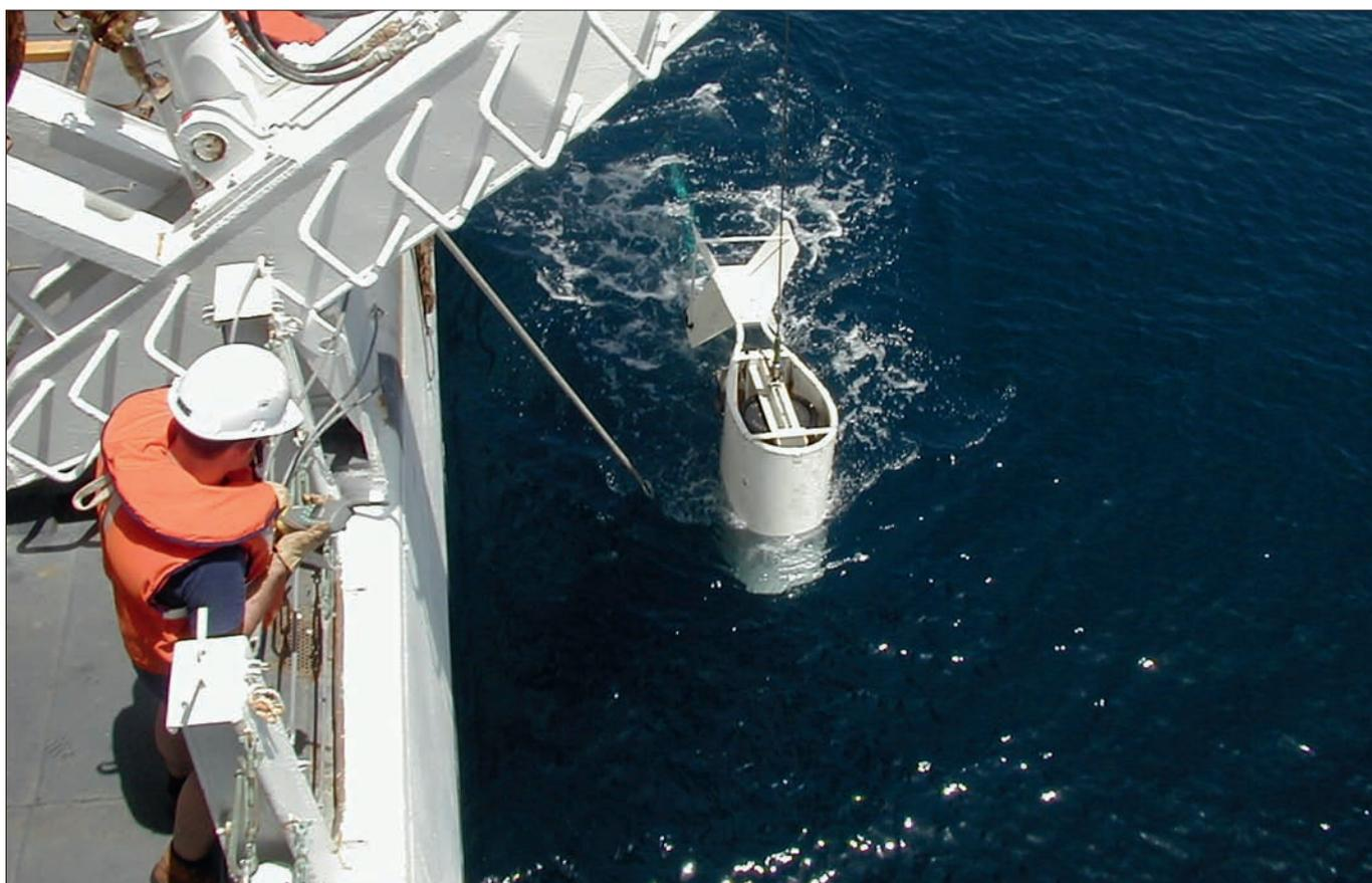
Photo n° 8 : source acoustique Télémaque BO *D'Entrecasteaux*
