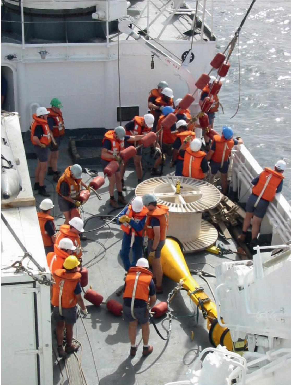
Photo n° 9 : préparation de la bouée d'écoute acoustique Télémaque BO *D'Entrecasteaux*
