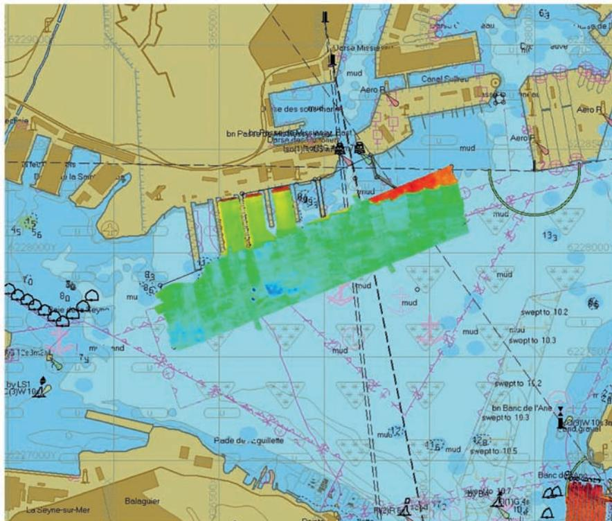
Sondage au niveau des appontements Milhaud dans la zone d'intérêt de la guerre des mines
