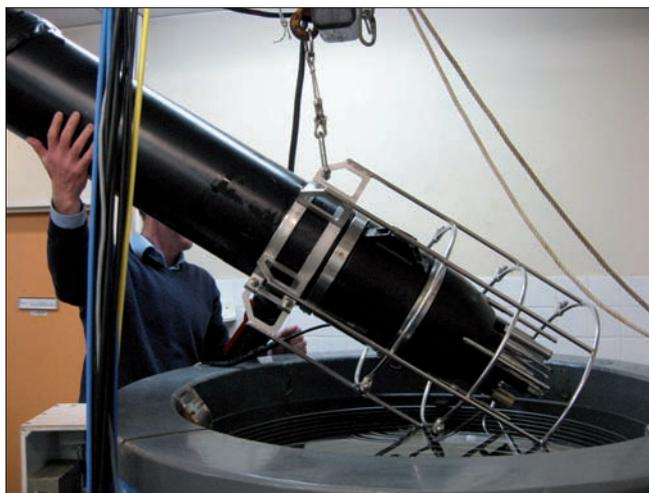
Figure 21 : Étalonnage d'un flotteur prototype multicapteurs (ASIP) au laboratoire de métrologie du SHOM.
