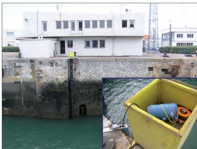
Figure 2 : Télémètre radar BM 70A installé dans un tube en PVC de 30 cm de diamètre et fixé au quai par des anneaux métalliques.
