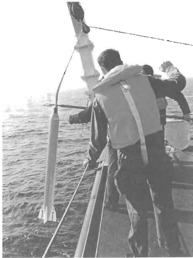
Mise à l'eau d'un manémètre SMM92 pour évaluation.
