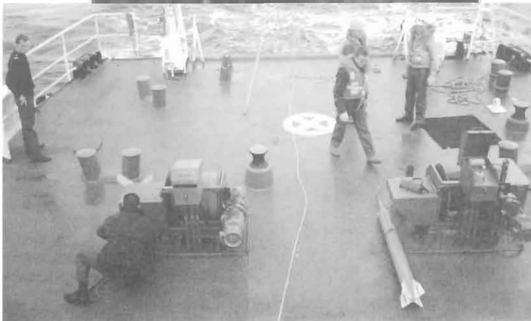
Le magnétomètre SMM92, avec ses quatre ailerons stabilisateurs sur le pont arrière du BH2 Lapérouse .
