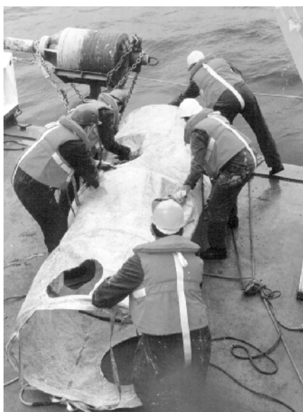
Mise à l'eau d'une bouée SURDRIF (ici la drogue) à partir du BO D'Entrecasteaux pendant la campagne ARCANE 96.
