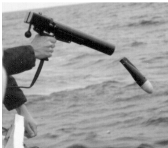
Largage d'une sonde XBT avec un lanceur à main.
