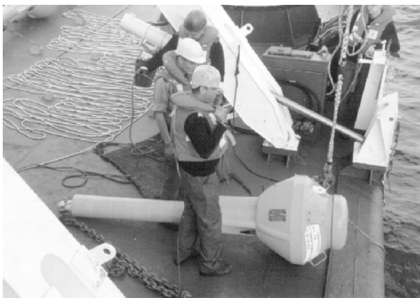
Une MARISONDE en cours de mise à l'eau sur le pont milieu du BO D'Entrecasteaux .
