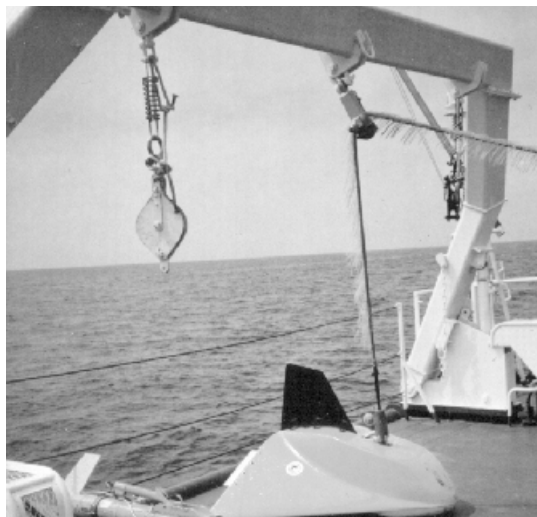
Poissons du sondeur latéral et du sondeur de sédiments à bord du BH2 Lapérouse .
