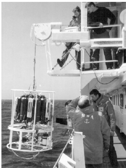
Mise à l'eau de la bathysonde SBE type 911+ avec multi-échantillonneur et bouteilles à renversement à bord du BO D'Entrecasteaux pendant la campagne ARCANE 97
