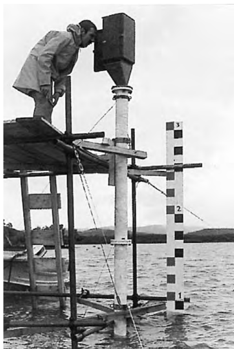
« Contrôle d'un marégraphe à flotteur à Mayotte »
