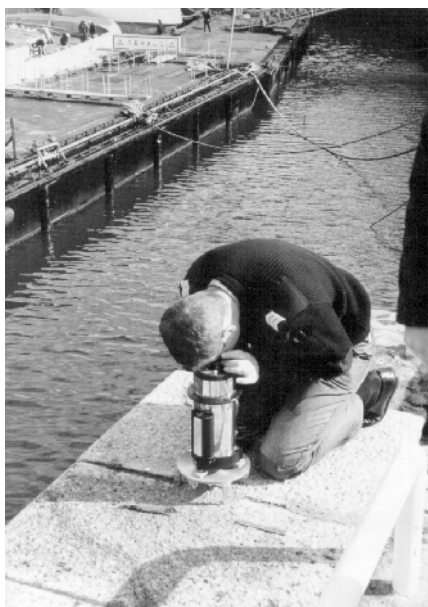
Gravimètre terrestre Worden pour le rattachement des stations gravimétriques de référence réalisées à bord des bâtiments.
