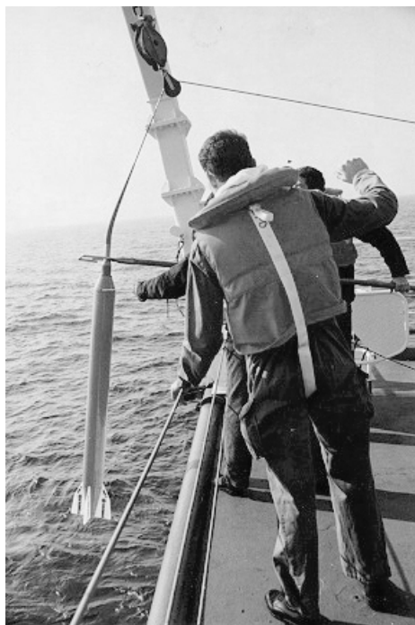
Mise à l'eau du magnétomètre Thomson SMM-2 à bord du BH2 Lapérouse .
