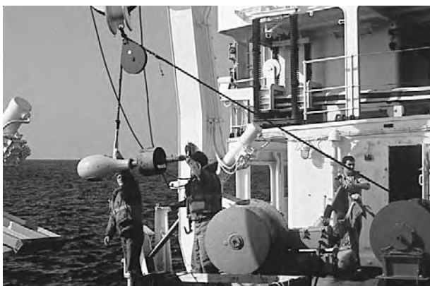
« Mise à l'eau du transducteur d'émission pour une localisation par balises acoustiques »
