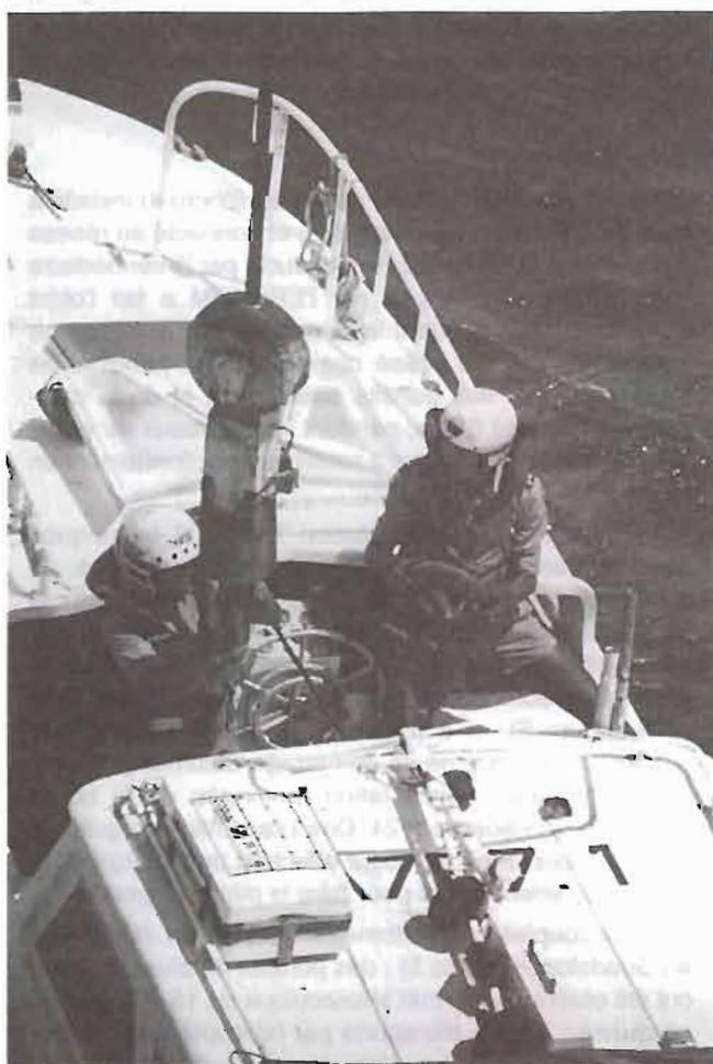
Photo 2. Récupération de la vedette n°1 : mise en place du croc de la grue
