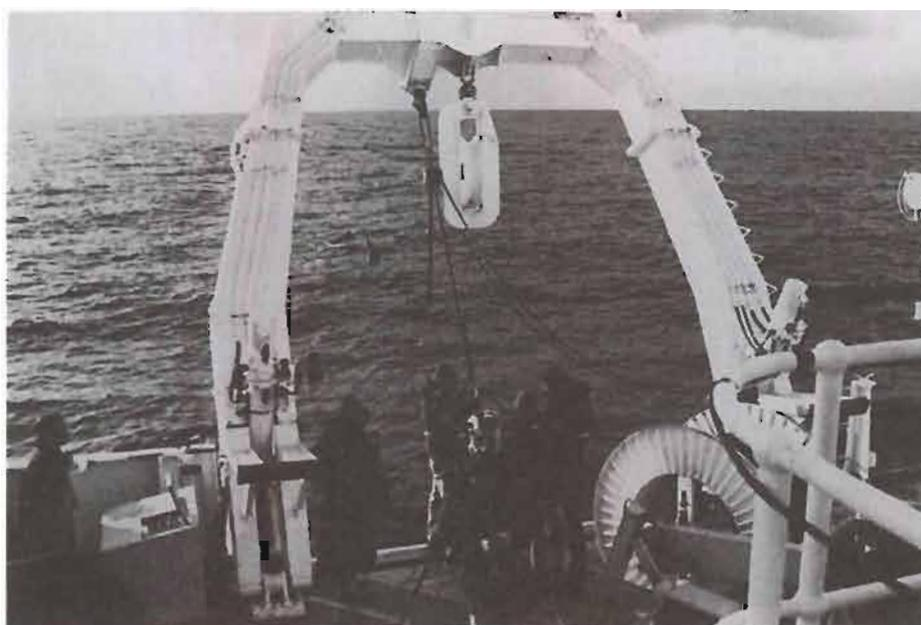
Photo 20. Récupération de la ligne d'hydrophones par le travers pendant la campagne Measured Stride
