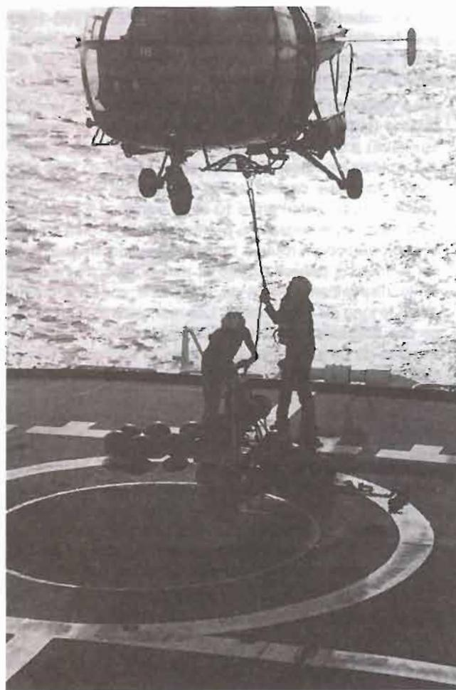
Photo 3. Accrochage en sling sous l'Alouette III d'un marégraphe Suber SLS 13
