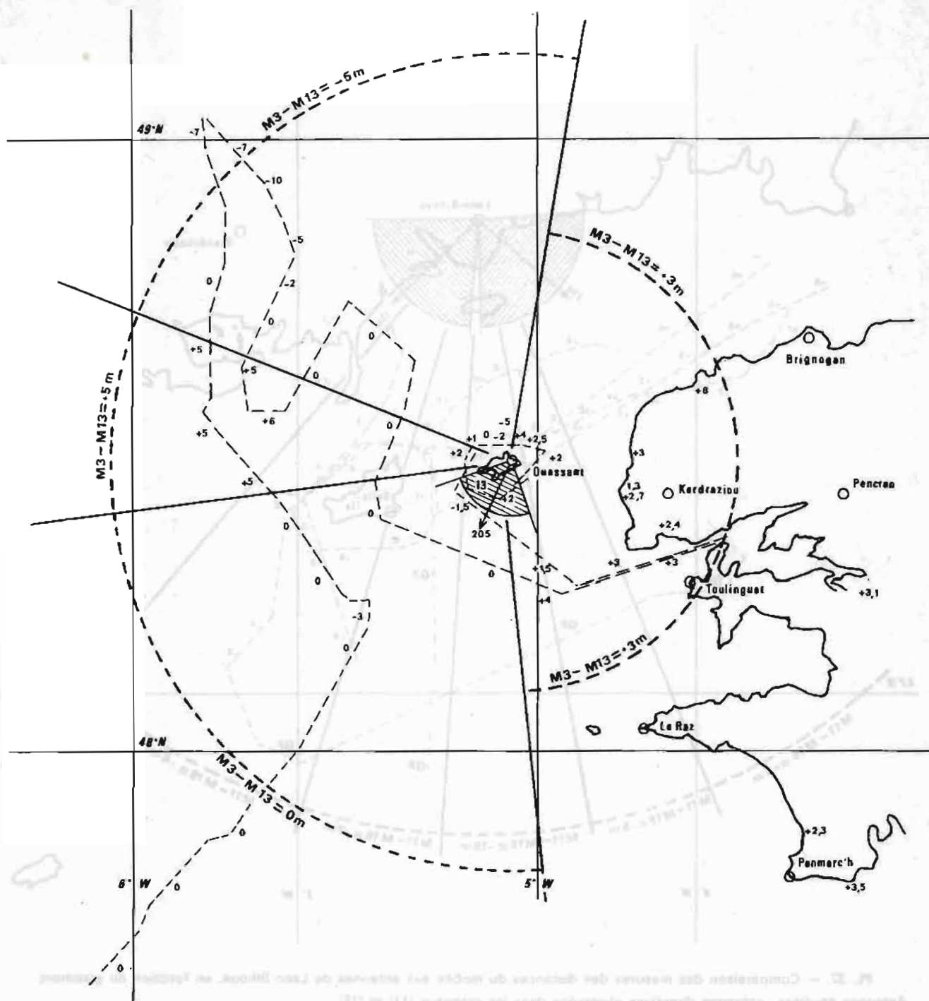
PL. 38. — Comparaison des mesures de distances du mobile aux antennes Syledis de la station de Ouessant, en fonction du gisement.
