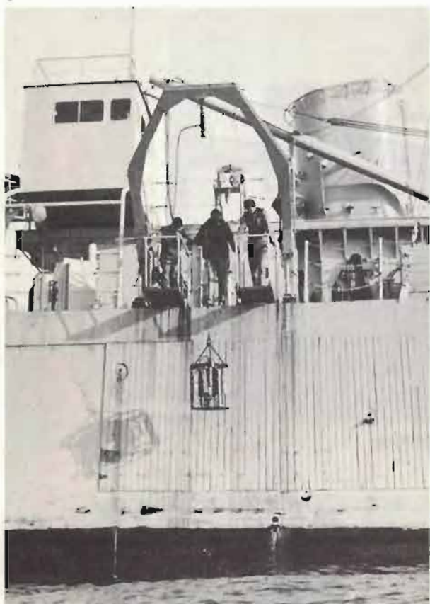
Portique latéral en cabine ou sont regroupés les commandes du portique et des treuils
