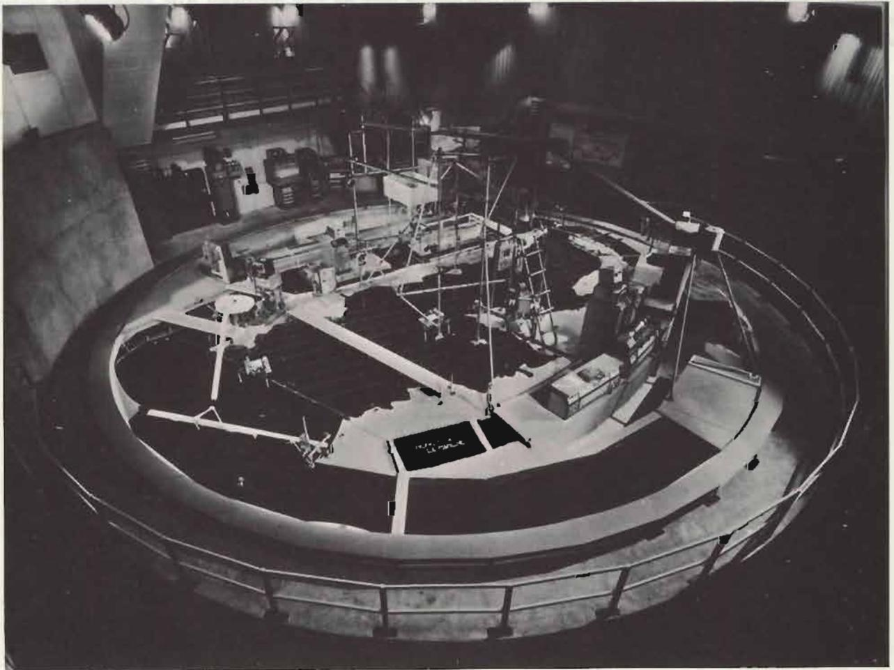
Vue générale de la plate-forme tournante de l'Institut de Mécanique de Grenoble, sur laquelle est placé le modèle de la Manche utilisé pour établir cet atlas.
