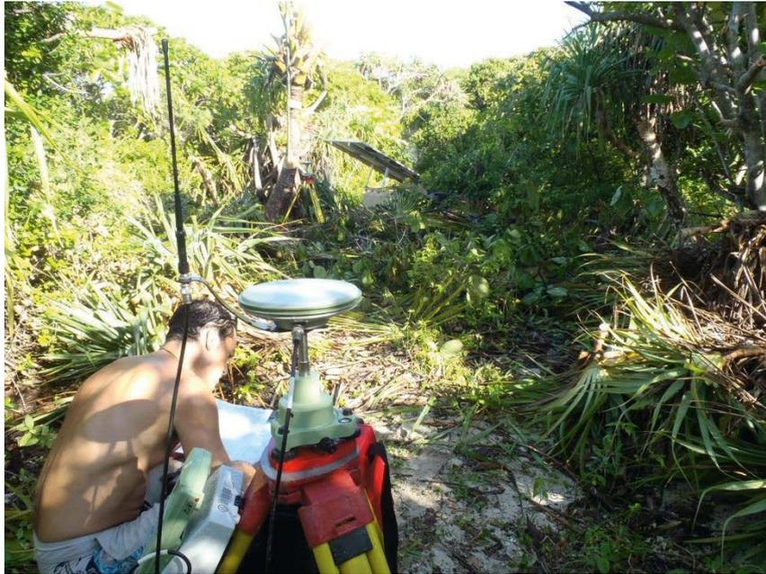
Station GPS de référence – Ile des Pins – levé Sarcelle/Ile des Pins 2013
