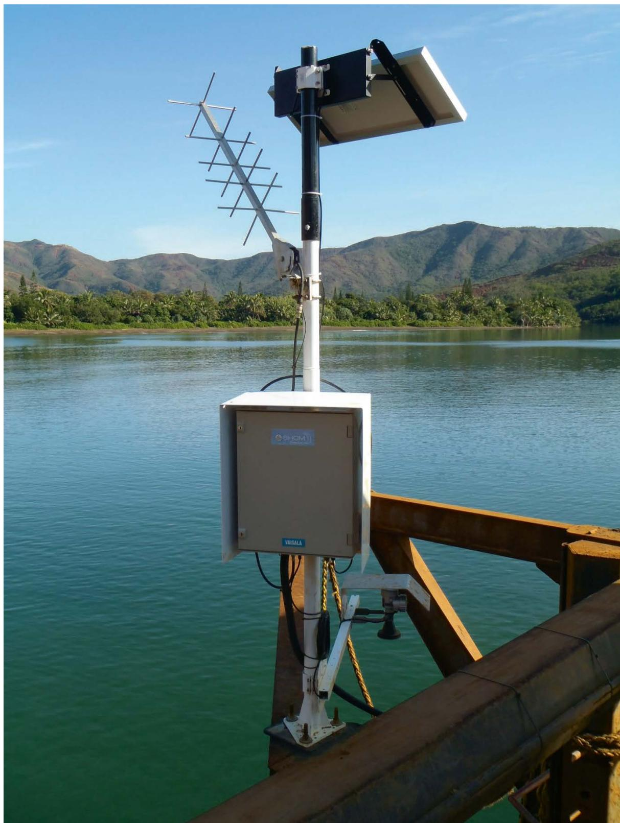
*Marégraphe de Ouinné (capteur radar, centrale d'acquisition, antenne de transmission satellite, alimentation par panneau solaire, hors photo : capteur de pression immergé)*
