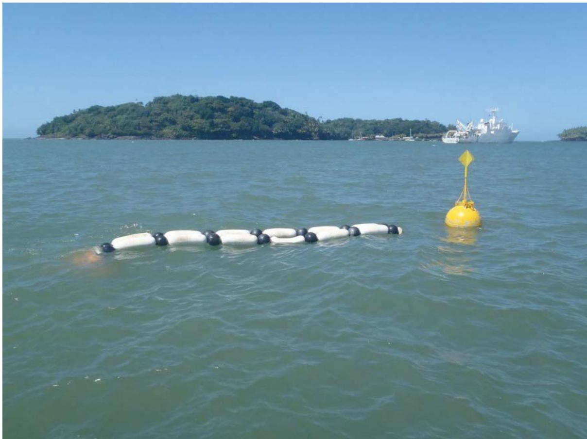
*Figure 3 : profileur de courant au point fixe mouillé sur ligne de pare-battage aux Îles du Salut.*
