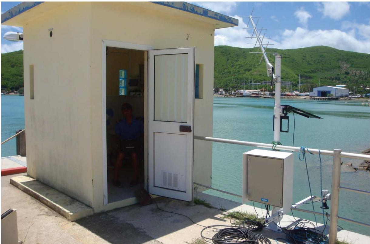
*L'abri du MCN de Numbo. A droite, un marégraphe « tsunami » en test par l'IETA Yves-Marie Tanguy avant installation.*
